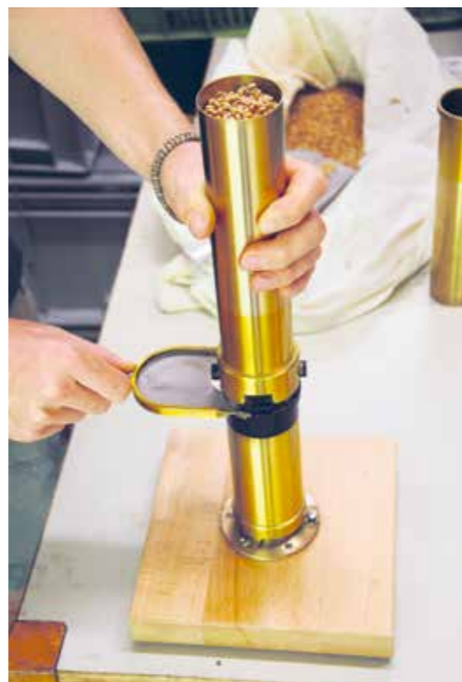
Fig. 1: Il peso ettolitrico viene misurato con uno strumento apposito con una capacità di 0,25 l.
