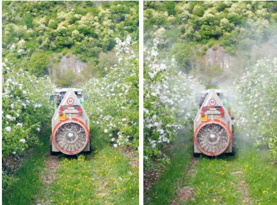
Fig. 1: Trattando con ugelli antideriva ITR 80 015 (a sinistra) a confronto con ugelli a cono ATR gialli e distribuendo un volume d'acqua pari a 166 l/m di altezza delle piante/ha non si forma alcuna nebulizzazione visibile.
